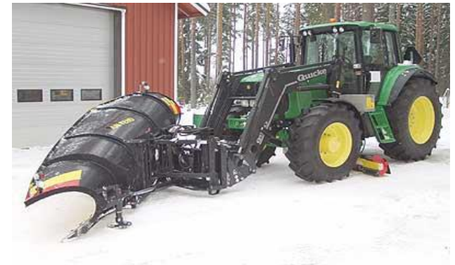
Talvihöyläys onnistuu myös traktorin alusterällä
