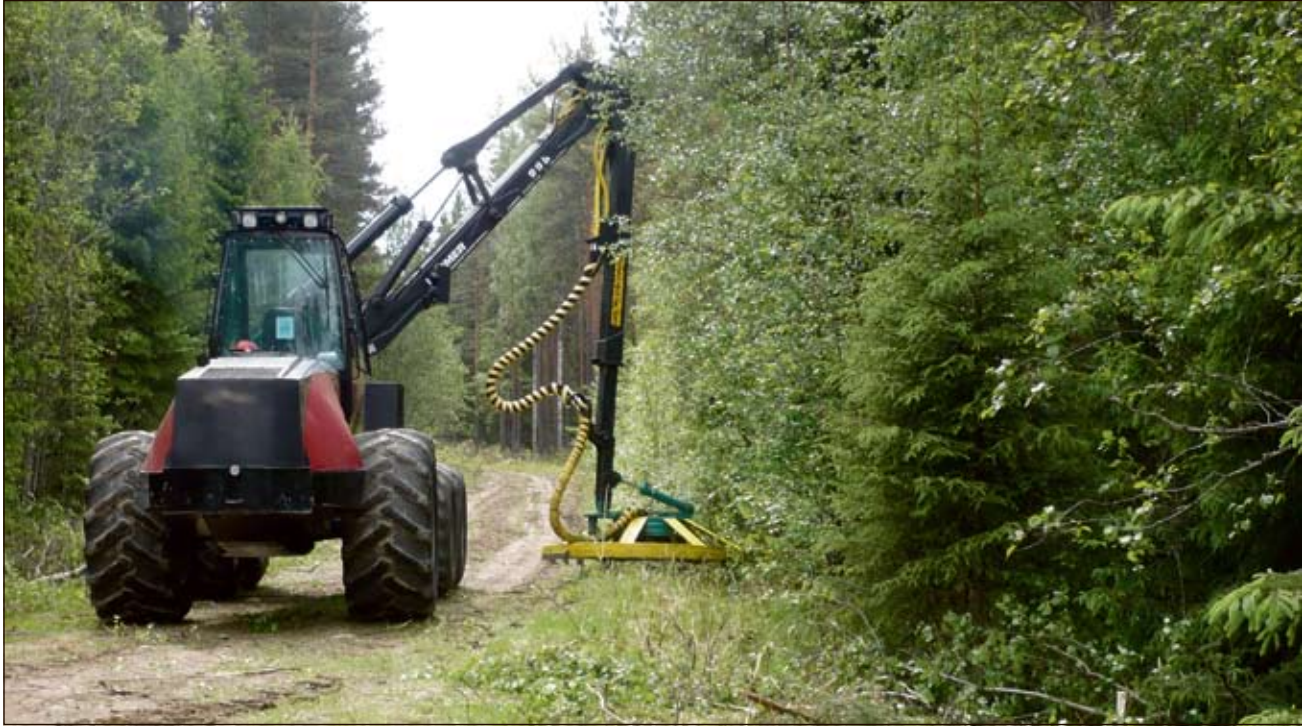
Koneyrittäjiltä löytyy kalustoa joka lähtöön. Kuvassa hakkuukoneesta on laitettu tienhoitokone reunusvesakoiden niittoon.
