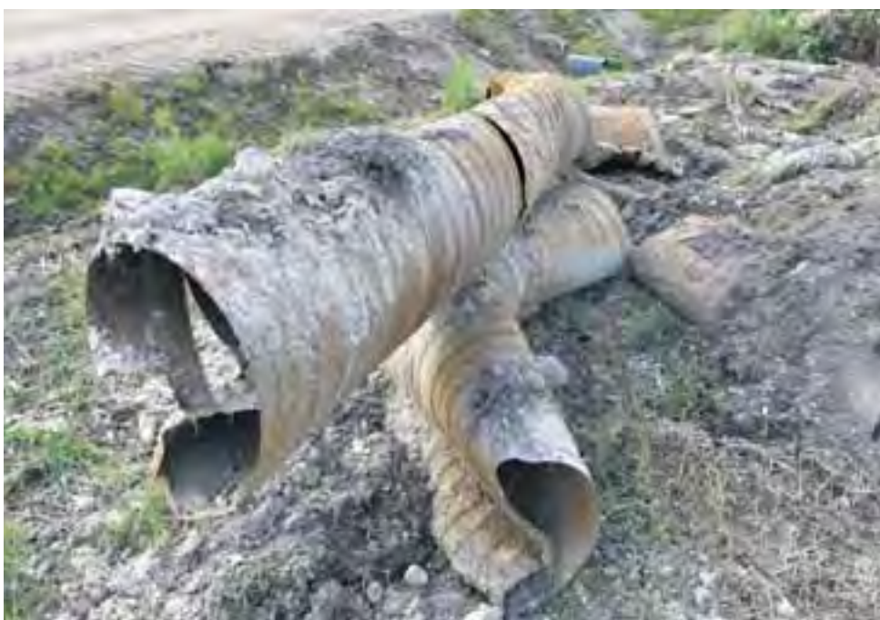
Huonosti pintakäsittely peltirumpu syöpy nopeasti käyttökelvottomaksi ja raskaitten kuormitusten vaikutuksesta pettää lopullisesti.
