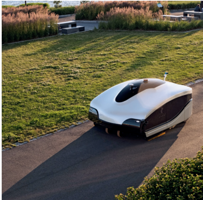
Trombian tienhoitokoneet ovat lähes valmiita tulemaan liikenteeseen. Loikka täysautomaatioon operaatiotasolle Level 5 hitaissa koneissa on tehtävissä.
