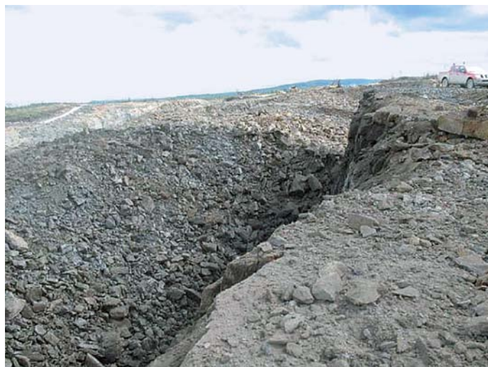
Onnistuneen räjäytyksen tunnusmerkit: Rintauksen juuri on avoin ja lohkokarekoko ihanteellinen. Räjäytys on tehty prillatulla Kemiitti 510:llä, rivien välillä hidastus 109 ms, ruutukoko 8.2 m².
