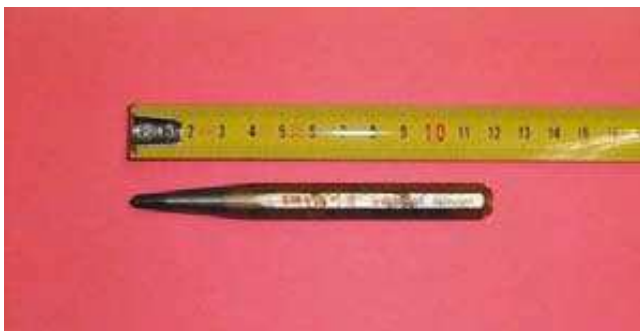
Kuva 1. Pistepuikko. Pistepuikon kärjen halkaisijan tulee olla 4 - 5 mm.
