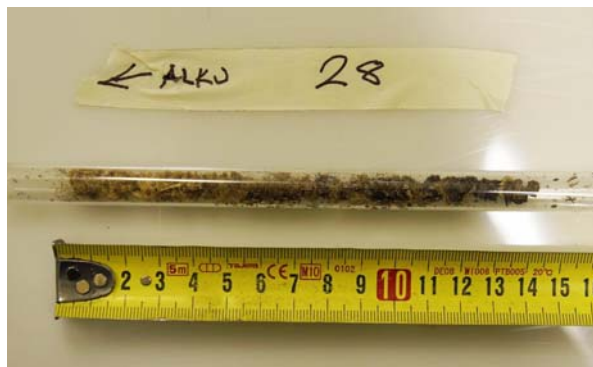
Kuva 5. Kasvukairanäyte mikroporausta vastaavasta kohdasta.
