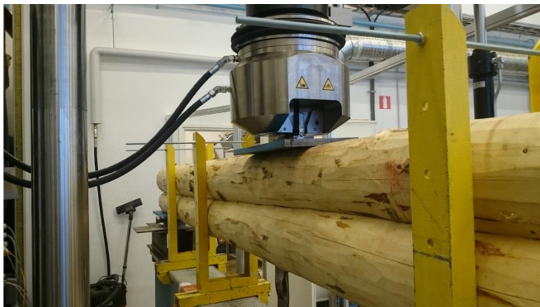
KUVA 47. Nurjahdustuet asennettuna (Eskelinen 2016)
