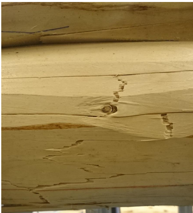
KUVA 48. Hammastetun vaarnapalkin taivutusmurto (Eskelinen 2016)
