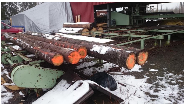
KUVA 43. Puiden valinta suoritettu, merkattu ja siirretty odottamaan kuorimista (Eskelinen 2015)
