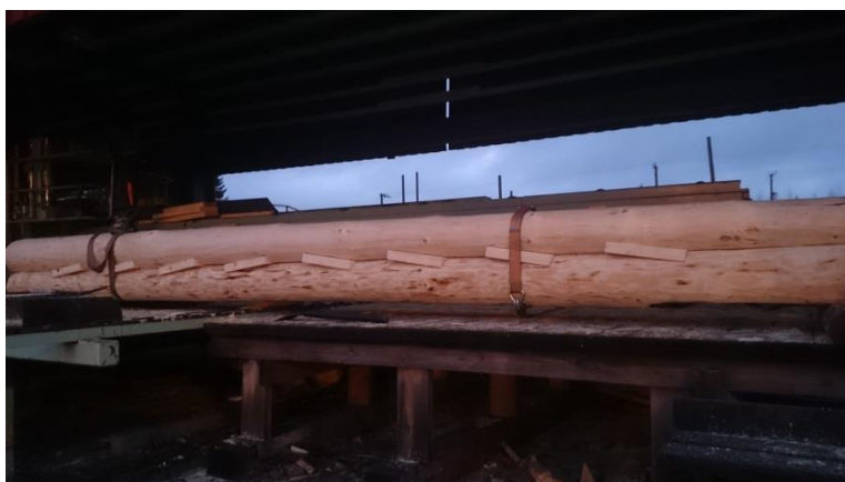
KUVA 29. Palikka vaarnapalkki lähes valmiina kokoamisvaiheessa (Eskelinen 2015)
