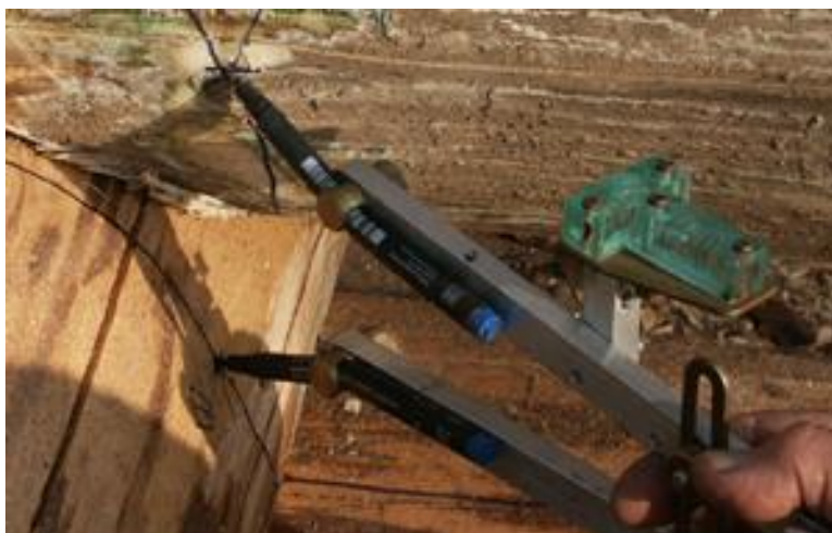
KUVA 20. Kalibroitava hirsivara. Nurkkasalvoksen tasapinnan pisteiden siirtäminen (boisbrut.free.fr.)
