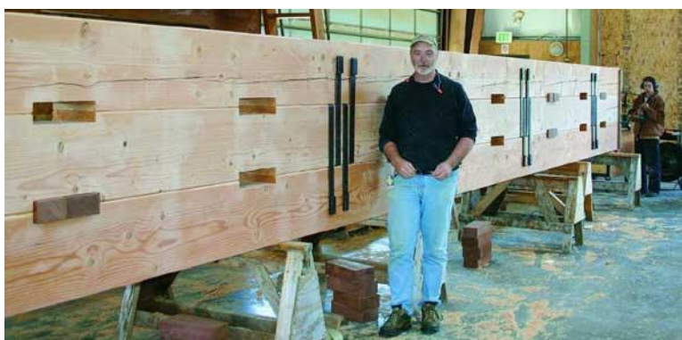
KUVA 17. Massiivisesta sahatavarasta valmistettu kolmiosainen vaarnapalkki (Brungraber & Miller 2009)
